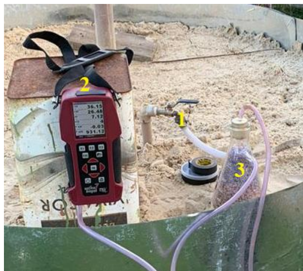
Figura 30 - Medição da composição do biogás no digestor Sertanejo (1) com analisador de biogás Optima7 (2) acoplado ao trap desumidificador (5).
