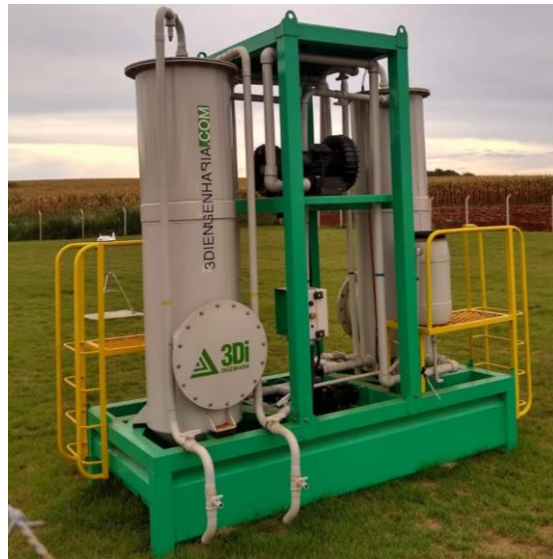
Figura 22 - Equipamento industrial para purificação parcial de biogás ( H_2O e H_2S ) em Entre Rios do Oeste - PR.
